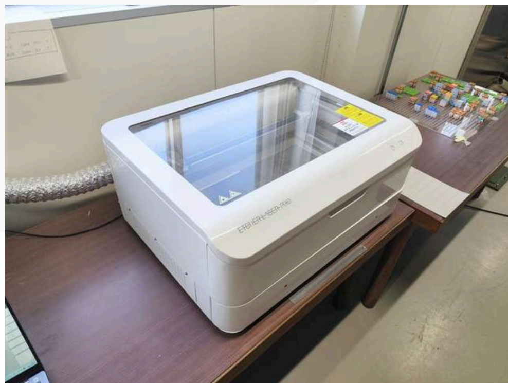
レーザー加工機 Etcher Laser Pro …橋梁模型の部品制作
