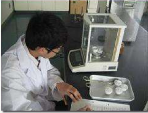
①るつぼの質量を測定します。
