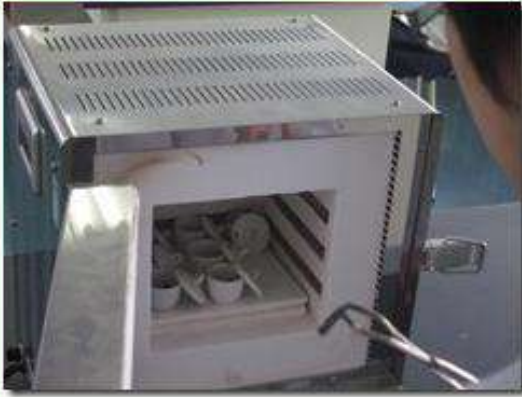
③電気炉で試料を灰化します。
