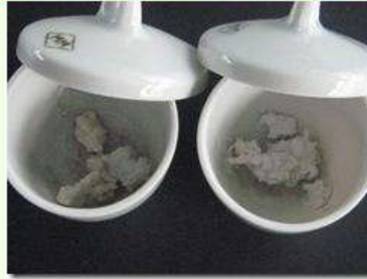
④試料は白く灰になり、この灰の質量から灰分量を算出しました。
