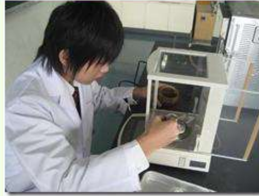
②るつぼに試料入れて、試料の質量を測定します。
