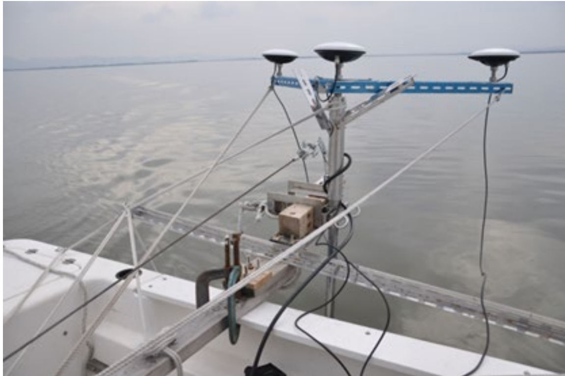
写真2：ウインチによる巻き取り解放時の支柱とGNSSアンテナ，令和7年6月12日，児島湖
