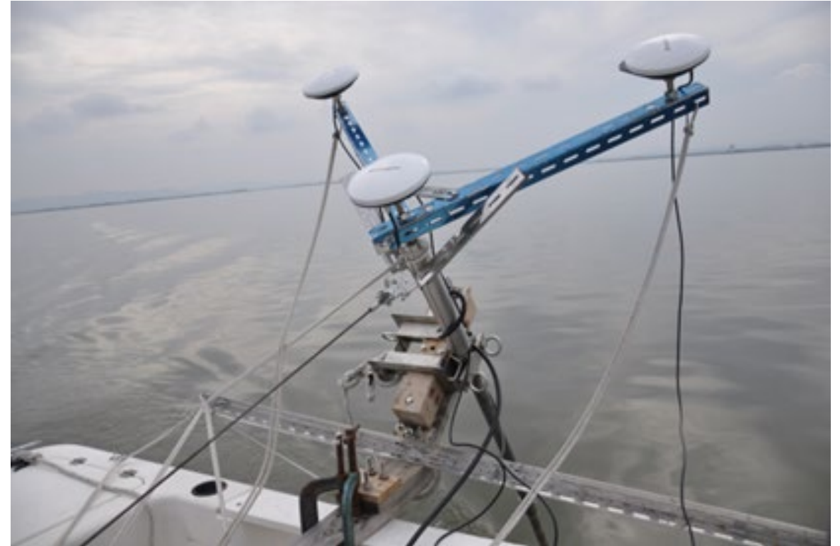
写真3：ウインチ巻き取り時の支柱とGNSSアンテナ，令和7年6月12日，児島湖
