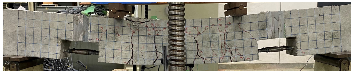
載荷試験時の連結桁供試体
