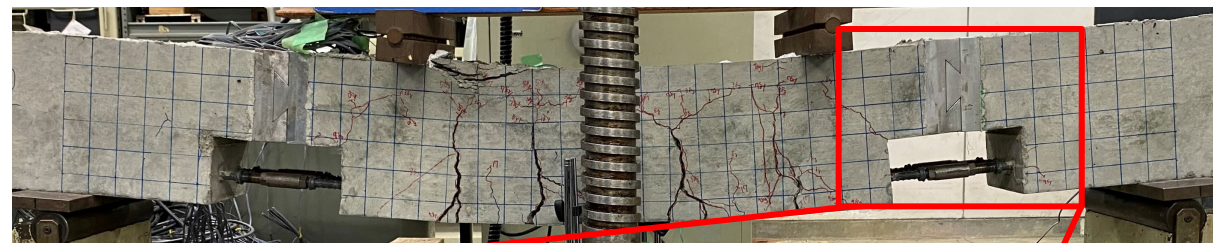
載荷試験時の連結桁供試体
