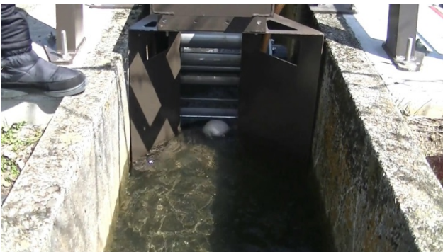
図 24 羽根数 z = 18 の場合の雪玉の様子
