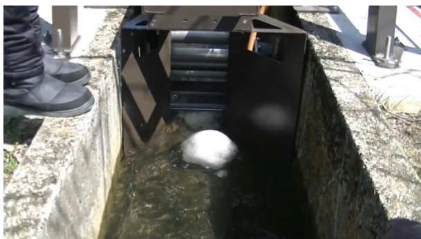
図 30 羽根数 z = 18 の場合の雪玉の様子
