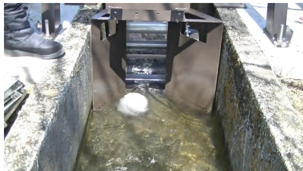
図 28 羽根数 z = 9 の場合の雪玉の様子
