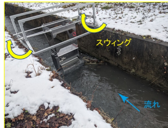
図12 スイングによる雪塊の回避
