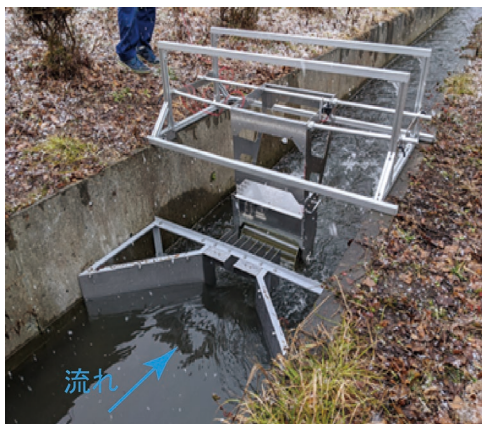
図 15 集水・雪塊粉碎装置が装備された水車システム
