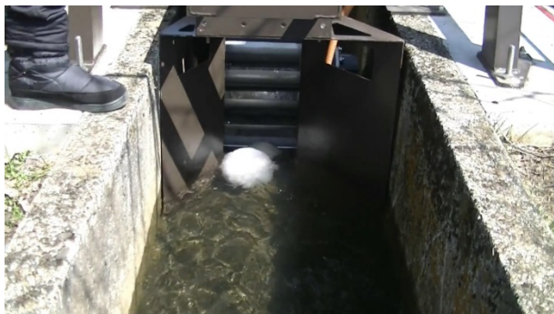
図 27 羽根数 z = 18 の場合の雪玉の様子
