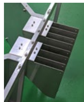
図14 雪塊粉碎装置の詳細
