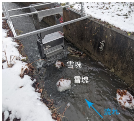
図11 水路を流下する雪塊と水車
