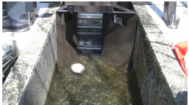
図 25 羽根数 z = 9 の場合の雪玉の様子
